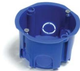
Коробка для подштукатурного монтажа используется в комбинации с гофрированными или гладкими трубами для разветвления кабелей, проводов и установки электроустановочных изделий евростандарта с межвинтовым расстоянием 60 мм. Стыковочные узлы позволяют осуществлять групповой монтаж электроустановочных изделий с межосевым расстоянием 71 мм.
