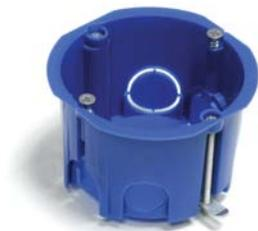
Коробка для подштукатурного монтажа используется в комбинации с гофрированными или гладкими трубами для разветвления кабелей, проводов и установки электроустановочных изделий евростандарта с межвинтовым расстоянием 60 мм. Коробка врезается в полые или гипсокартонные стены, крепление – самонарезаемыми винтами с металлическими лапками.
